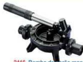
2416 Bomba de porão manual Bomba manual com duas posições de manuseamento, utilizada para esgotamento de porão, 720GPH (2724 litros/hora). Mangueira de 1-1/4". Dimensões: 272,5 x 140 x 140mm
