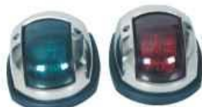
1243 Luz de navegação BB/BE - LED Em aço inox com lentes vermelha e verde, montagem externa 12V 100mA, visibilidade 1 milha. (PAR) Dimensões: 99 x 87 x 53mm
