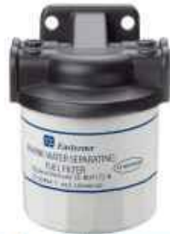
2185 Filtro de gasolina Mercury 10 Micron Kit de filtro de gasolina separador de água para uso em motores Mercury, com cabeça e elemento filtrante em alumínio. Repõe #35-807172, #35-80494-1 e Universal.
