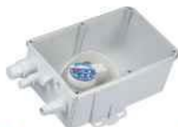
2164 Caixa coletora com bomba 700GPH Em PVC de alta resistência, sistema de dreno de porão para embarcações com bomba de 700GPH 12V já acoplada. Dimensões: 329 x 194 x 108mm
