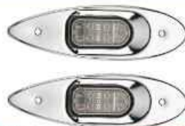
2182 Luz de navegação BB/BE LED Em aço inox, BB/BE, tipo olho de tubarão, 12V, 1,5W, 0,13A, com visibilidade de 2 milhas. (PAR) Dimensão: 196,6 x 24 x 59,7mm.
