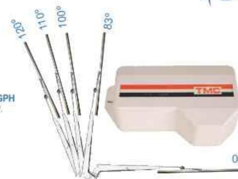
346/1886 Motor para limpador Motor com duas velocidades, ideal para serviços pesados com torque de 100Kg/cm. Acompanha caixa plástica para proteção do motor, pintura resistente a corrosão. Funciona em ângulos de 83, 100 e 120 graus, 12V e 1,5A. Dimensões: 208 x 112 x 66mm
