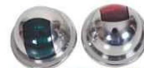
424 Luz de navegação BB/BE Em aço inox, com lentes vermelha e verde, montagem externa 12V, 10W, visibilidade de 2 milhas. (PAR) Dimensões: 72 x 40mm
