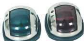
1242 Luz de navegação BB/BE Em aço inox, com lentes vermelha e verde, montagem externa 12V, 10W, visibilidade de 1 milha. (PAR) Dimensões: 99 x 87 x 53mm
